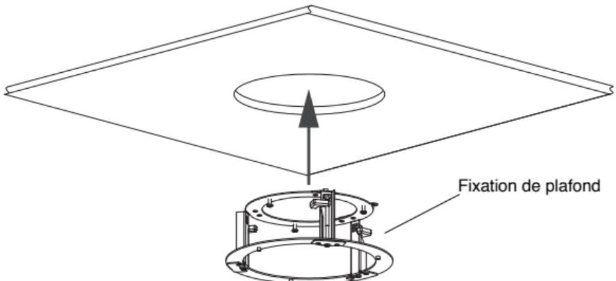
4. Serrez les vis de serrage jusqu'à ce que la base soit solidement fixée au plafond.
