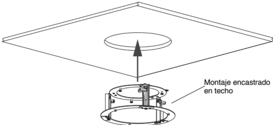
4. Apriete los tres tornillos de fijación hasta que el montaje esté sujeto en el techo.
