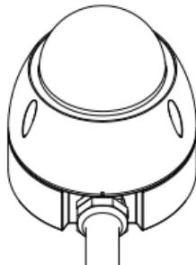
4. Montieren Sie den Sockel mit den mitgelieferten Schrauben und Dübeln an der Decke bzw. der Wand. Verwenden Sie die mitgelieferten Gummidichtungsringe, um eine wasserfeste Dichtung zwischen den Schrauben und dem Sockel herzustellen.
