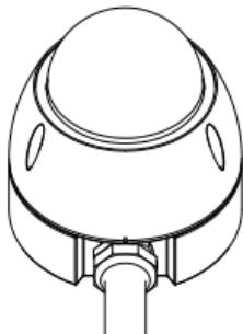
4. Installare la base sul soffitto/muro utilizzando le viti e i tasselli di fissaggio in dotazione. Utilizzare le rondelle di gomma in dotazione per creare una chiusura sigillata contro l'acqua nello spazio tra le viti e la base.
