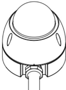
4. Fixez la base sur le plafond/mur au moyen des vis et des ancrages. Utilisez les rondelles d'étanchéité fournies pour créer une étanchéité à l'eau entre les vis et la base.
