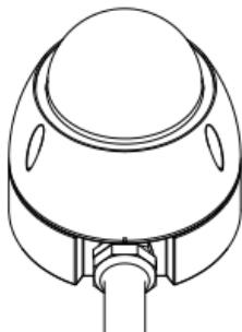
4. Monte a base no teto/parede usando os parafusos e âncoras fornecidos. Use as arruelas de borracha fornecidas para criar hermeticidade entre os parafusos e a base.
