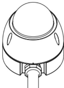
4. Monte la base en el techo/muro usando los tornillos y anclajes suministrados. Utilice las arandelas de caucho suministradas para crear un sellado hermético entre los tornillos y la base.
