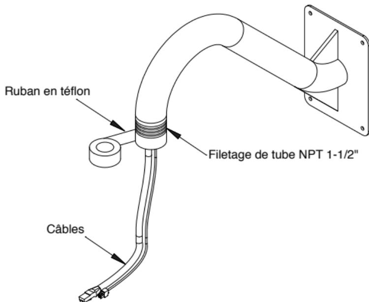
2. Vissez fermement la fixation en suspension dans le support de fixation de plafond ou mural.
