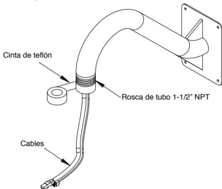
2. Atornille el montaje colgante en el soporte de montaje de la pared o el techo hasta que esté fijo.
