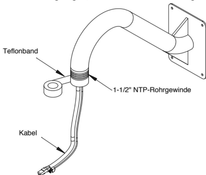
2. Schrauben Sie die Hängemontage fest an die Wand oder den Deckenmontagebügel.
