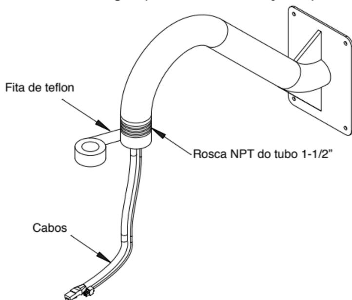
2. Parafuse o suporte pendente na parede ou teto até que esteja fixo.
